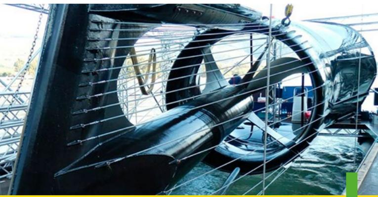
**Die Strom-Boje** ist eines der erfolgreichsten hydrokinetischen Projekte. Die Strom-Boje 3 ist für große Flüsse wie die Donau, den Rhein oder den Inn konzipiert. Mit ihrem 250 cm großen Rotor liefert sie bis zu 100 kW Nennleistung bei einer Fließgeschwindigkeit von 3,6 m/s. Je nach Standortqualität kann sie bis zu 350 MWh pro Jahr liefern.
